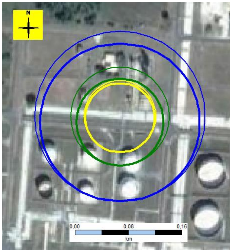
6.3.5.9.2.1.5. ábra I1 – Kései tócsatűz – hőszugárzás
