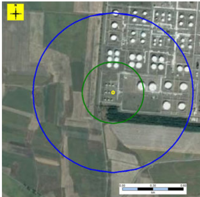
6.3.5.2.4.1.1. ábra B1 eseménysor Tűzgolyó - hőszugárzás
