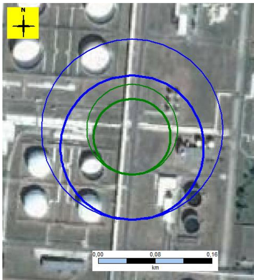
6.3.5.7.2.1.4. ábra G1 – Azonnali tócsatűz – hőszugárzás
