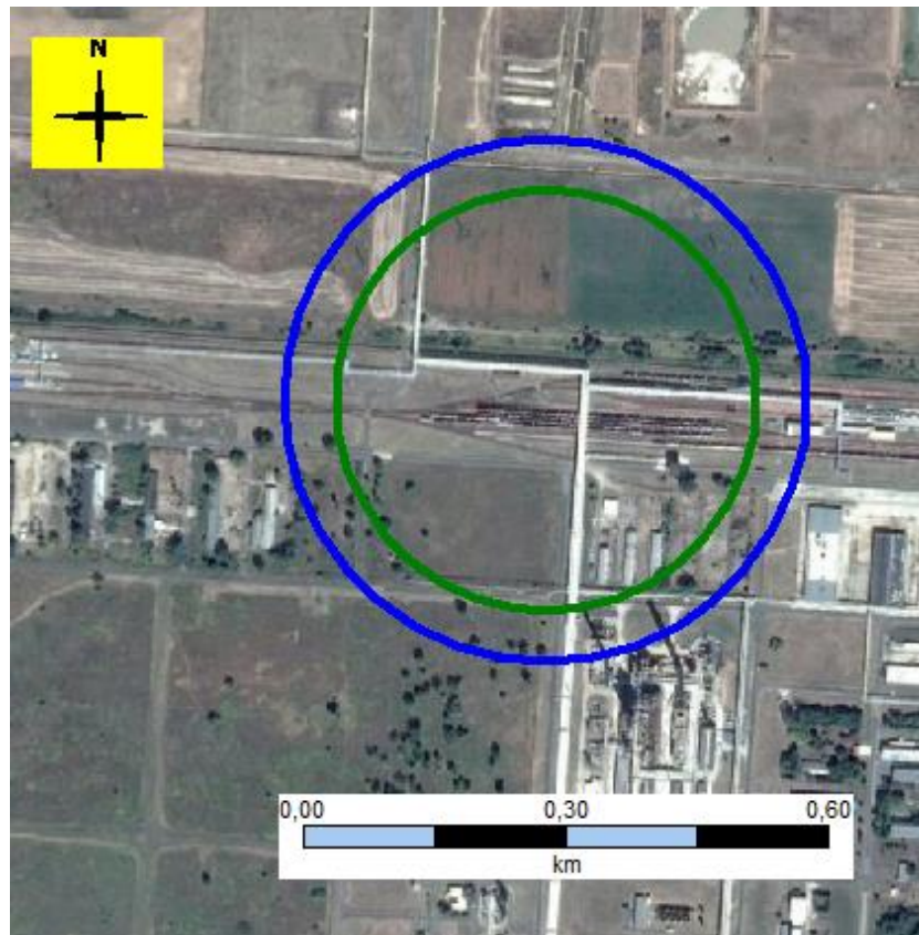
6.3.5.12.5.1.2. ábra L1 eseménysor Gőztűz - hőszugárzás
