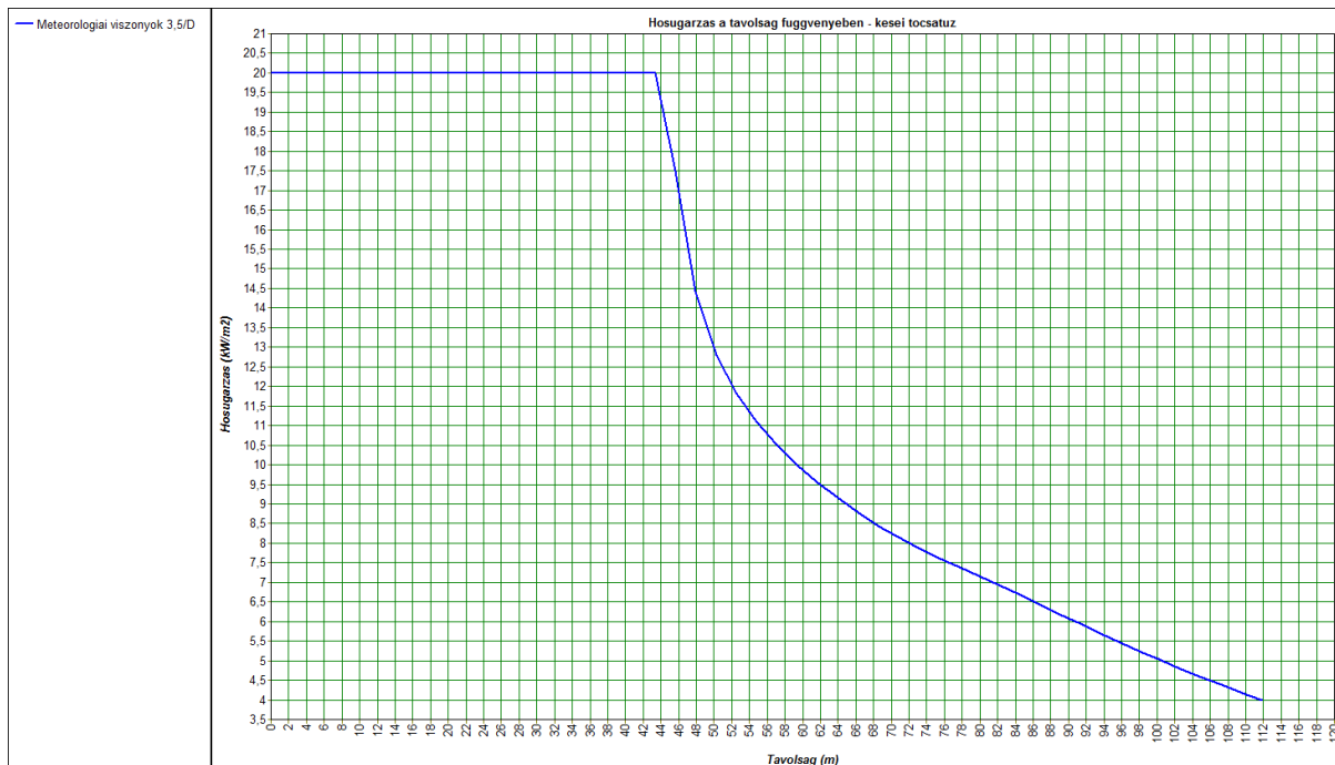
N3.1. ábra: TIT_N3_Gőz+Tócsa(Hőszugárzás vs. távolság - Tócsatűz)
