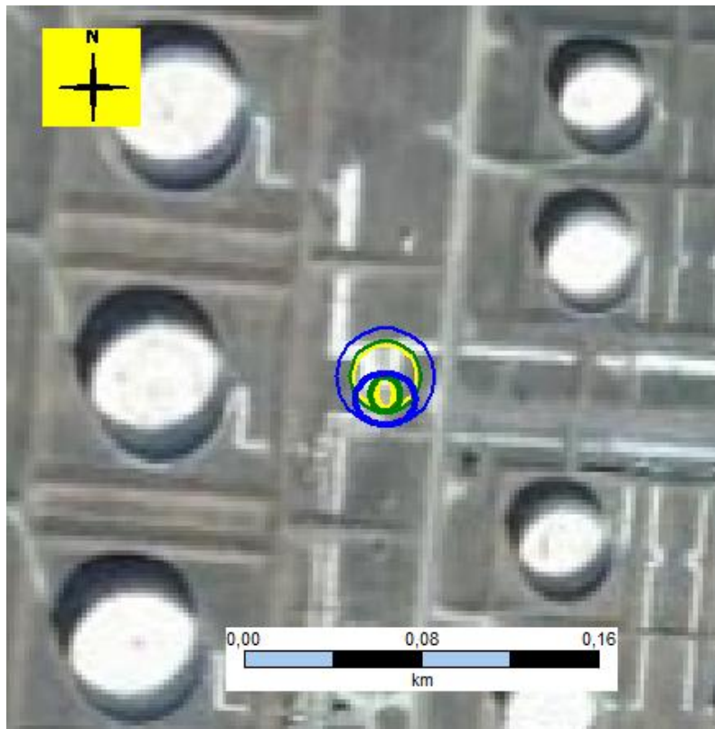
6.3.5.6.2.1.3. ábra F1 - Jettűz - hőszugárzás
