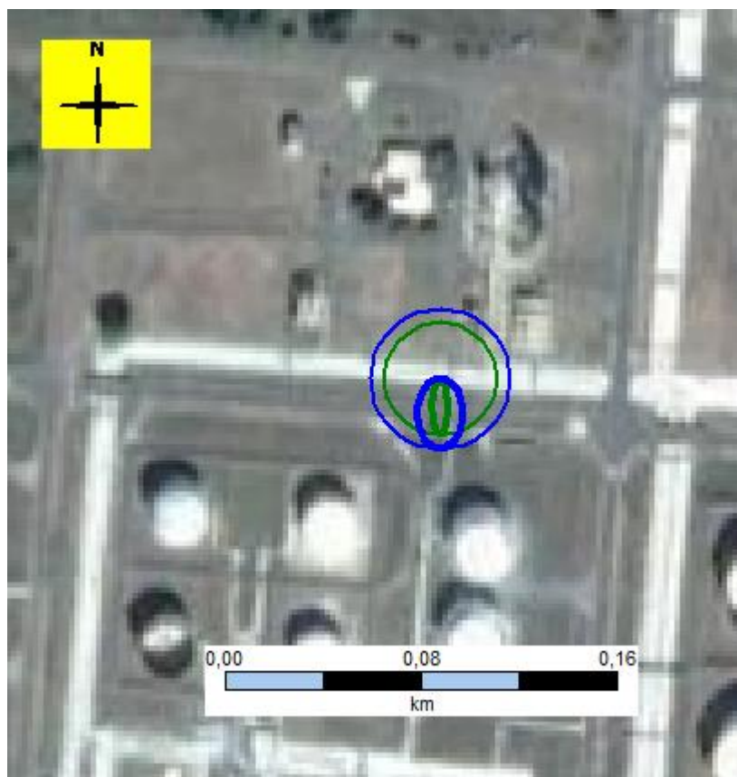
6.3.5.9.2.1.3. ábra I1 - Jettűz - hőszugárzás
