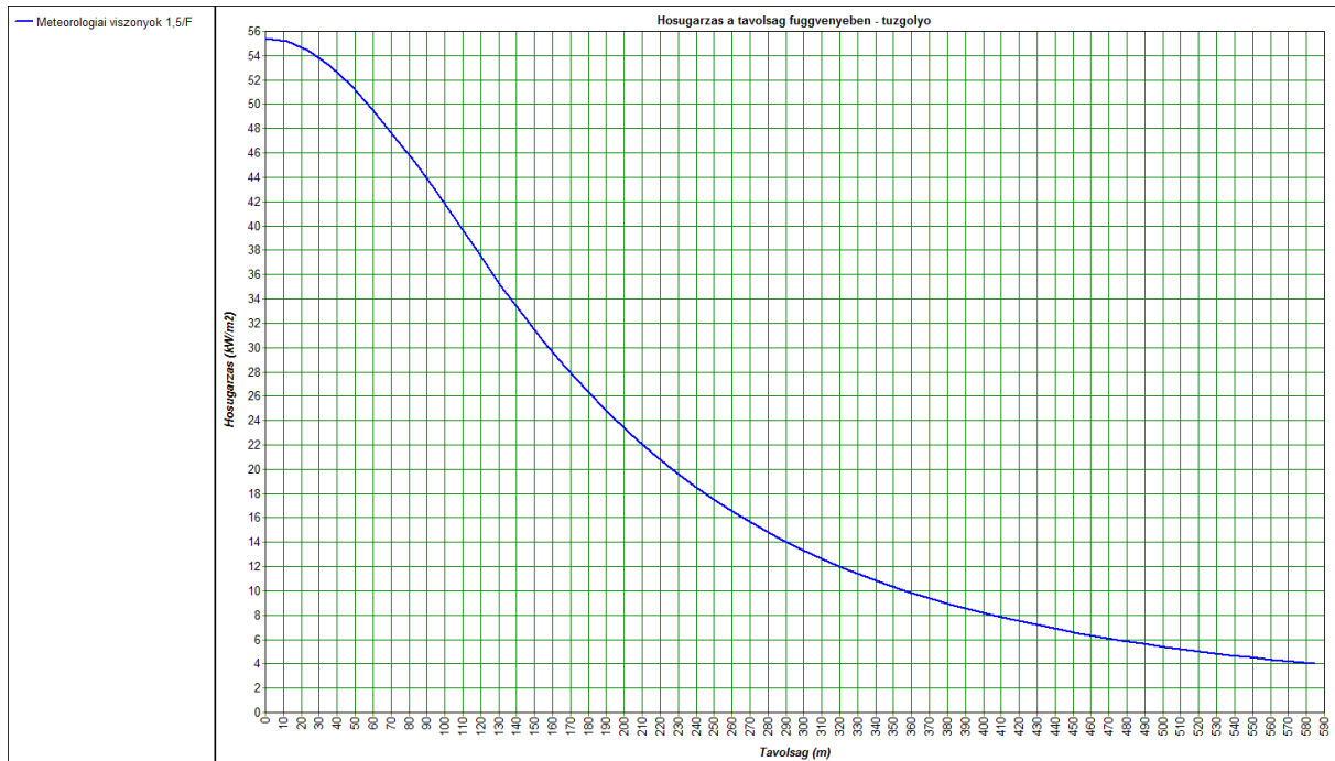
K1.1. ábra: TIT_K1_Tűzgolyó (Hőszugárzás vs. távolság – Fireball)
