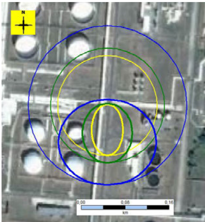
6.3.5.7.2.1.3. ábra G1 - Jettűz - hőszugárzás
