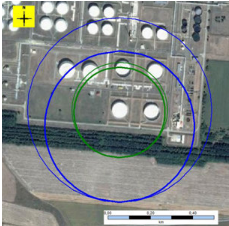
6.3.5.4.4.1.5. ábra D3 – Kései tócsatűz – hőszugárzás
