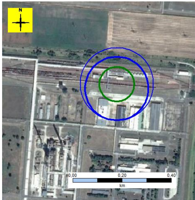
6.3.5.13.3.1.2. ábra M1 – Kései tócsatűz – hőszugárzás
