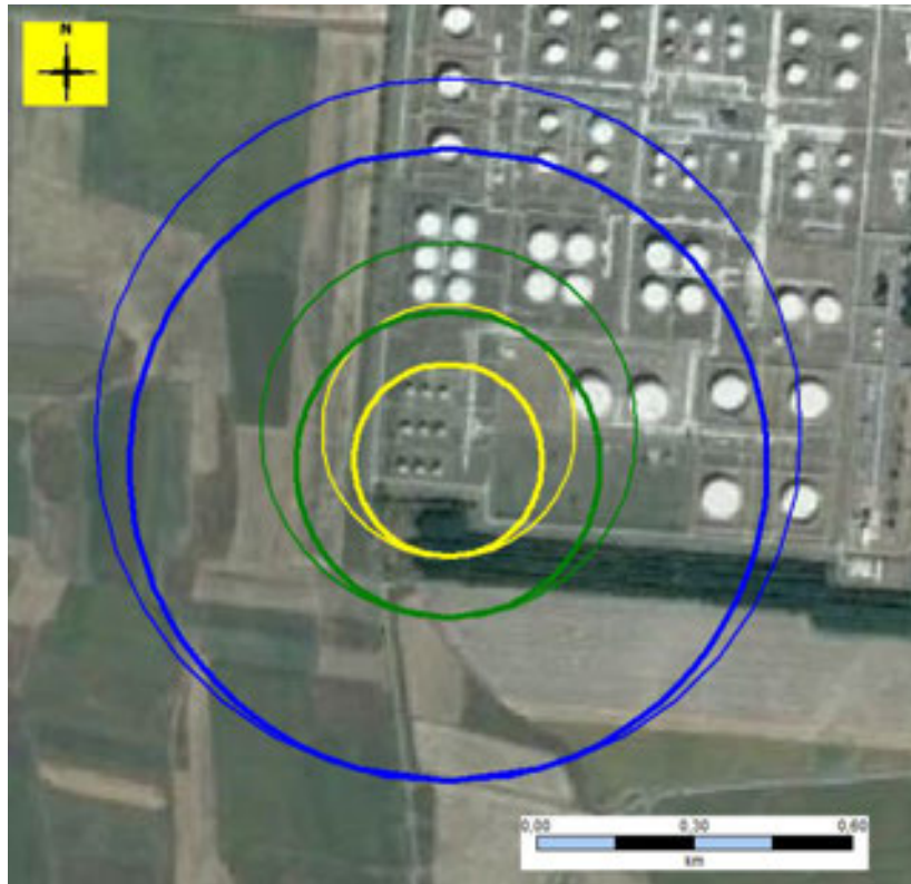
6.3.5.2.4.1.7. ábra B2 – Kései tócsatűz – hőszugárzás
