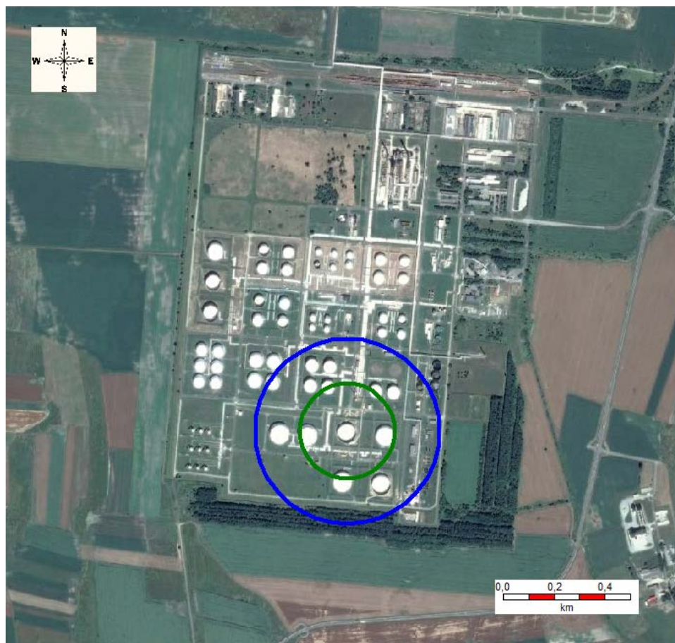
6.3.2.1.4.1.1. ábra A1 eseménysor Gőztűz - hőszugárzás
